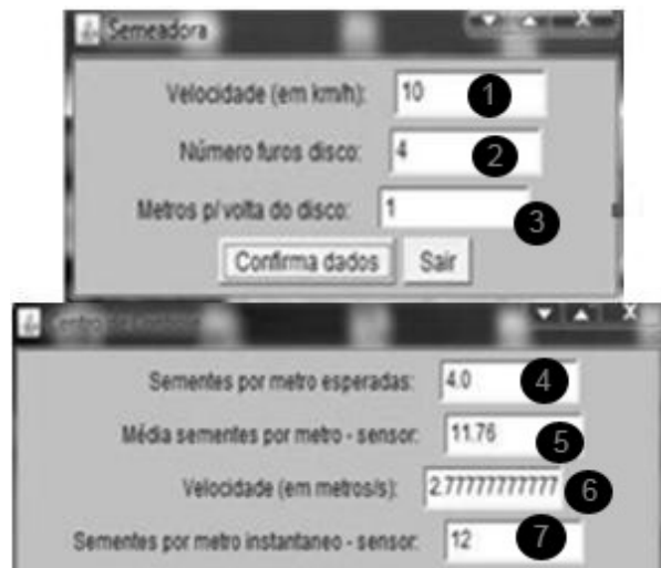
Fig. 4. Resultados obtidos na simulação do Sistema Eletrônico de Plantio com a utilização do elemento real adaptado ao DCB.
