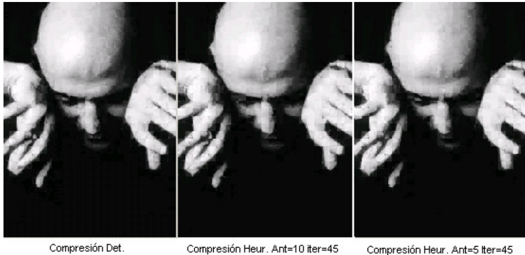
Fig. 4.2.2 - Comparación visual de resultados, variando hormigas e iteraciones
