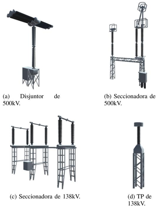
Figure 4: Equipamentos elétricos utilizados na subestação virtual.
