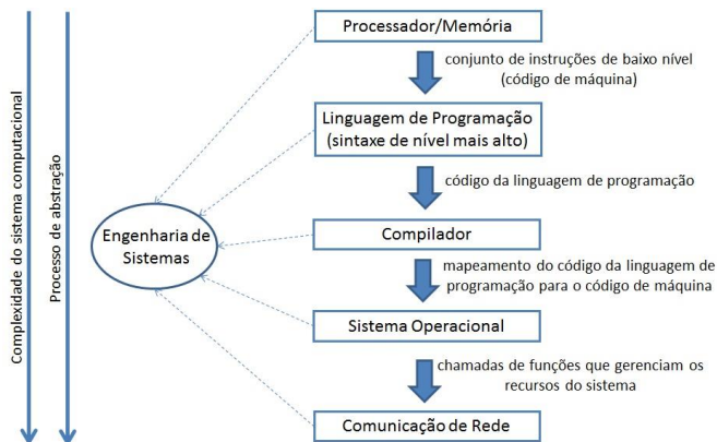
Fig. 1. Diagrama de um sistema computacional integrando o projeto de hardware e de software.
