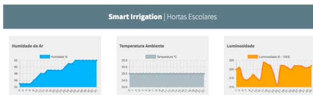
Fig. 4. Dashboard (painel de visualização) contendo os parâmetros coletados pelos sensores e exibidos em tempo real no navegador
